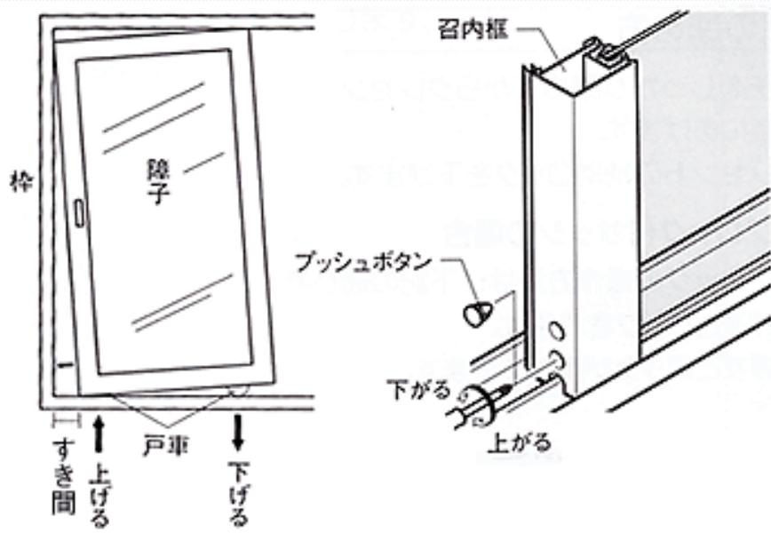
サッシが傾いてきて枠との間に隙間が発生してきたとのご相談がございます。サッシは傾きの調整ができます。通常2mm程を上下させる事が可能なのです。右・左の戸車を調整する事で隙間が解消できます。
