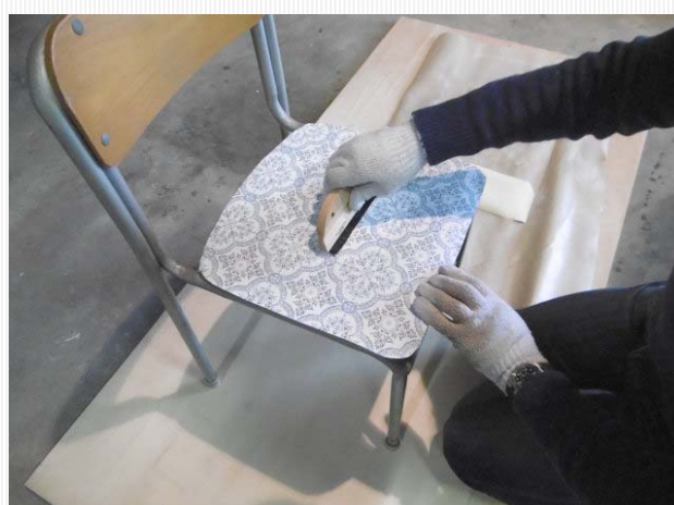
作業④ クロスを伸ばしながら、空気を抜くだけです
