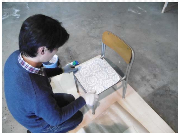
作業③ 糊付けしたクロスを椅子に貼り付けます
